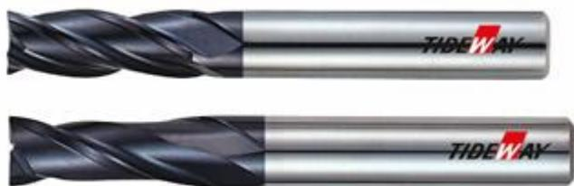
Применяются при обработке твердых материалов (до 45 HRC). Покрытие TiAlN - нитрид титана-алюминия обеспечивает более высокую износостойкость.
