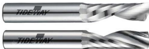
Применяются для раскроя всевозможных мягких материалов с образованием крупной стружки. Фрезы спроектированы специально для высоких оборотов, что обеспечивает высокую скорость обработки материала. Геометрия спиральной канавки позволяет беспрепятственно выводить стружку, это способствует хорошему охлаждению фрезы и увеличению срока ее эксплуатации.
