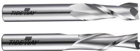
Фреза двухзаходная **с удалением стружки вверх** применяется для обработки с образованием более мелкой стружки и с меньшим съемом материала за один проход. Обрабатывают: алюминий, дерево, цветные металлы, текстолит, пластик ПВХ, акрил и др.
